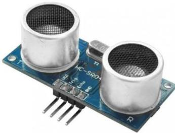
Figura 1: sensor ultrassônico.
